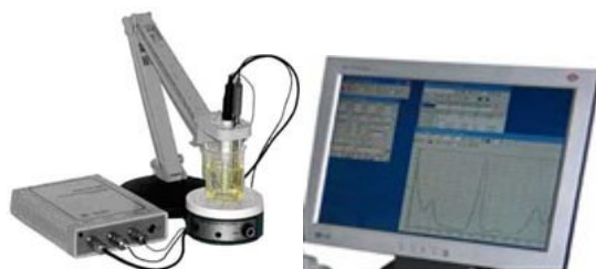
Фигура 1. Външен вид на апаратура, състояща се от инверсионен волтамперометър „Екотест – ВА” и компютър с работна програма.
