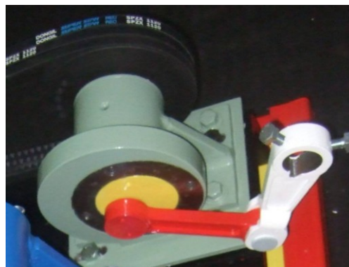
Фиг. 19 Шарнирен четиризвнен механизъм конструиран в Inventor
