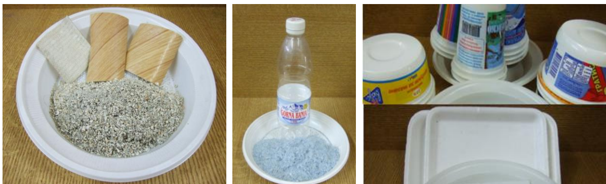
Фиг. 15 Проби, получени при смилане на полимери от различно естество
