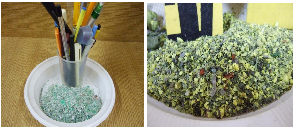
Фиг. 12 Проби, получени при смилането на твърди и крехки полимери
