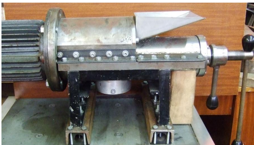
Фиг. 11 Експериментален образец на зъбна мелница за дезинтегриране на полимерни материали
