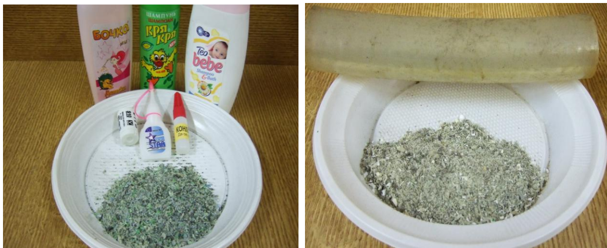
Фиг. 13 Проби, получени при смилането на еластични полимери
